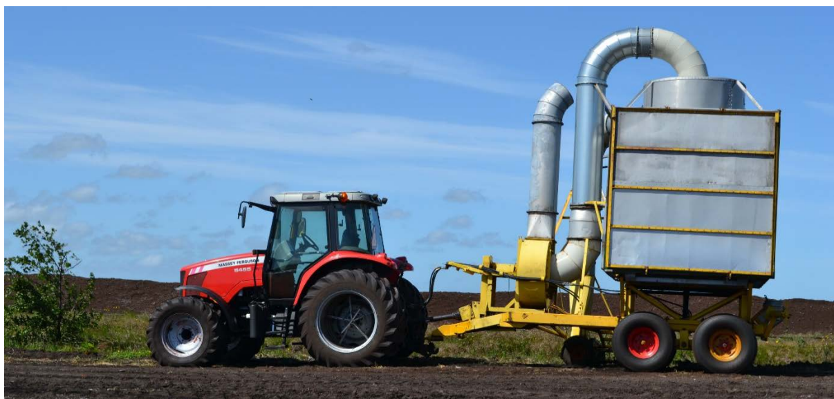
Bilde 1. Vakuumbøstmaskin for uttak av torv
