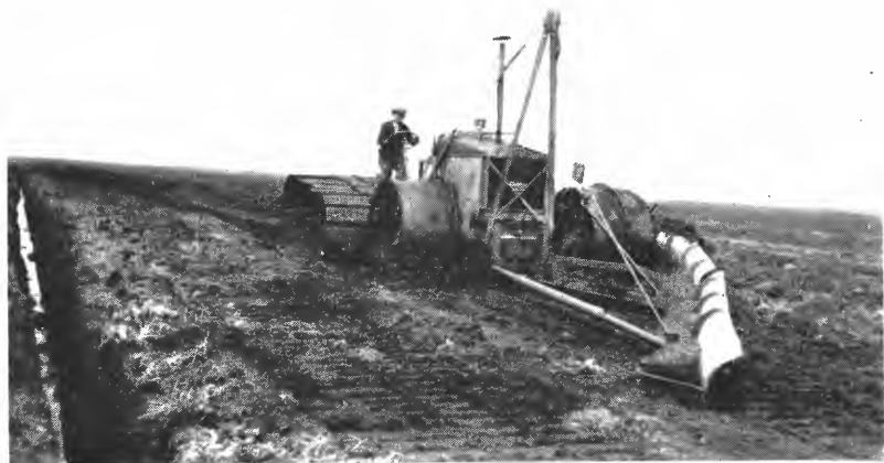
Fig. 3. Ridger, maskin som skraper det lufttørre materiale i en liten drill.
