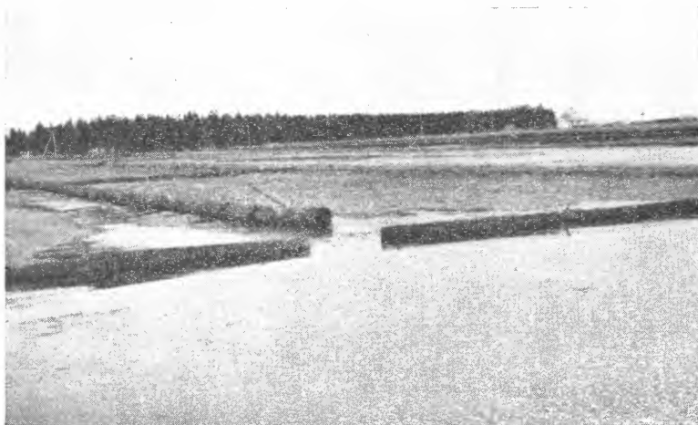
Fig. 3. Tørkefeltet for hydropeatanlegget ved «A/S Kaas Briketter». I forgrunnen nettopp utpumpet torrvelling. (Fot. O. L.)
