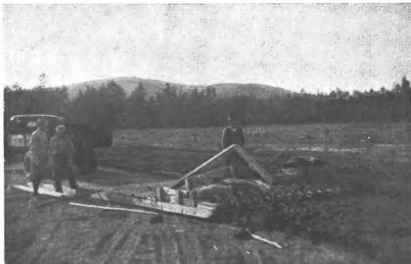
Fig. 4. Torvmassen formes med en såkalt «feltpresse» som trekkes frem av bilen etter at massen er tømt ut. Torva deles opp i lengderetningen med kniver påmontert feltpressen og i tverretningen med et håndredskap. (Fra Pukerudmyra brenntorvanlegg, Sokna. Fot. Aa. L.).
