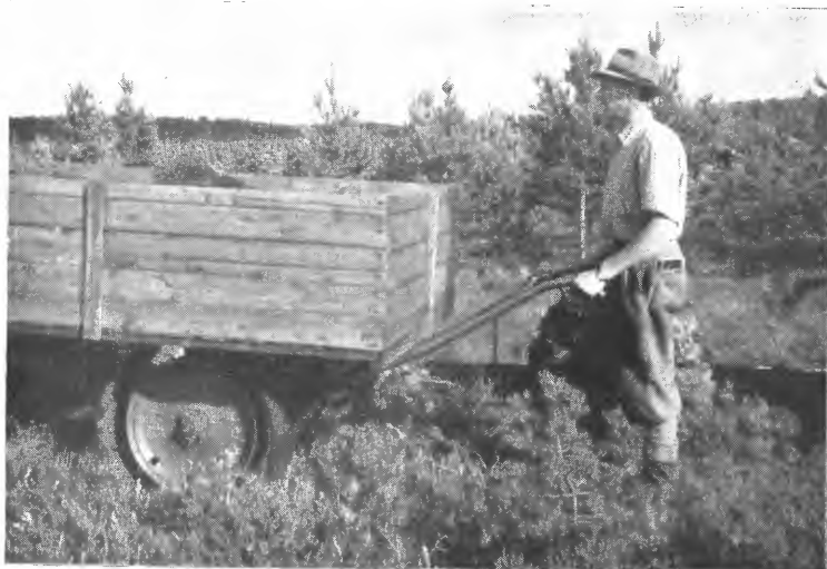
Fig 2. Allen motorsl maskin ombygget for transport av torv. (Fot. Aa. L.)
