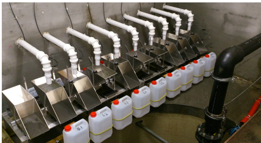
Figur 2. Vannføringsmåling gjøres ved å telle antall vipp med vippekarene og uttak av vannprøver skjer ved oppsamling av delprøver hver gang vannet renner over kannene.
