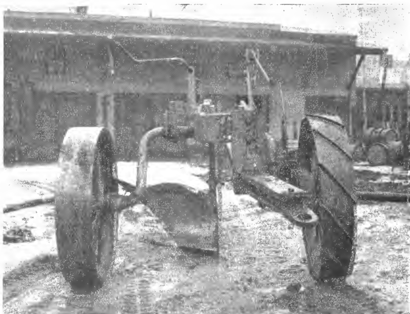
Fig. 3. Nyodlingsplog av Fiskars fabrikat. Den väger c:a 1500 kg och kan vända 45 cm tjocka och 80 cm breda tiltor i torvmarken.
