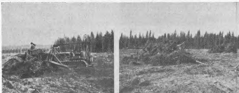
Fig. 2. Fra Sikosuo nydyrkingsområde ved Tohmajärvi i Nord-Karelen, ca. 50 km sør-øst for Joensuu. Stubbene kjøres til slutt sammen i hauger
