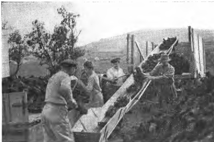
Fig. 2. Brødrene Sørliens transportør. Opplossing av brenntorv på bil, 3 mann «måker» på torv fra traktortilhengeren, mens 1 mann kaster på torv fra en haug. (Fot.: P. H.)
