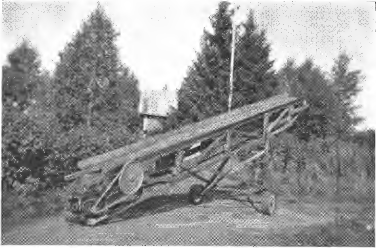
Fig. 1. Ordings torvtransportør. Høyden kan reguleres ved hjelp av understellet. (Fot.: Aa. L.)
