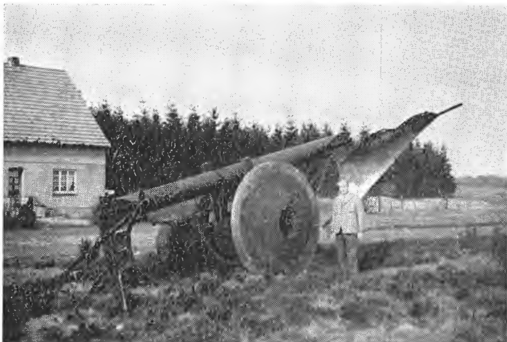
Fig. 2. Plog for dyparbeiding av jord med aurbellelag. Pløyedybde inntil 1,1 m, fårbreidde ca. 0,45 m.
