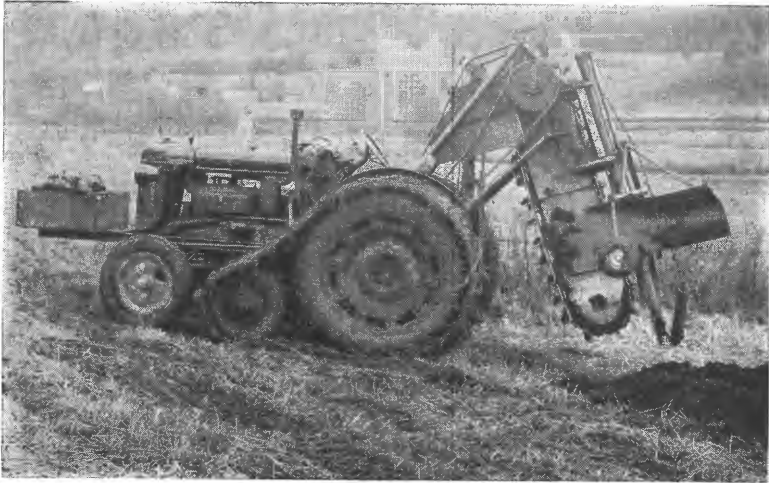
Nyengets beltegrøftemaskin i hevet stilling. Maskinen heves og senkes hydraulisk. (Fot. P. N.)
