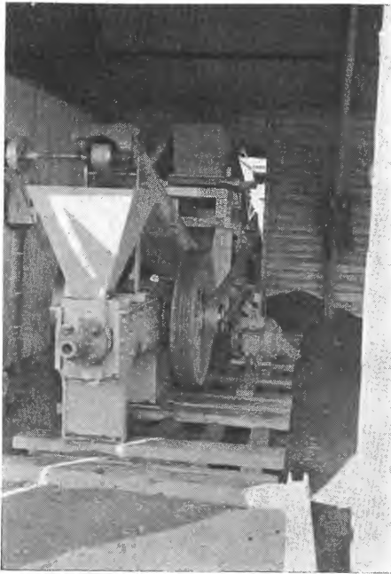
Fig. 3. Rimas formbrenselpresse. Som drivkraft nyttes elektrisk motor.
