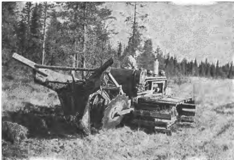
Vikeidploegen i arbeid på Hjellummyra, Furnes almenning. Ploegen er montert på traktorens hydraulikk. (Fot. Aa. L.)
