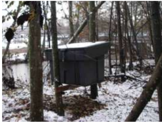
Figur 3. Stasjon 1 nedstrøms Kølbrua og nedstrøms utslipp via Wøyenbekken. Stasjonen ble flyttet noe oppstrøms og satt på stativ etter flomproblemer våren 2006.
