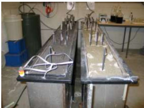
Figur 4. Karforsøk med dimensjonene: lengde 3 m, bredde 0,5 m og dybde 0,75 m, hvor filtermaterialene lettklinker og skjellsand ble sammenlignet. Foto: Anne Kristine Søvik.
