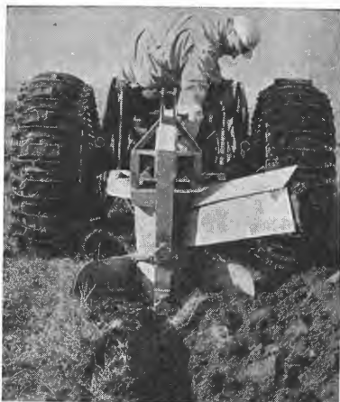
Fig. 3 og 4. Grøfteskruen. Grøfteskruen er også montert til traktorens trepunkt og reguleres hydraulisk idet toppstaget er skiftet ut med en dobbeltvirkende sylinder som hever og senker maskinen. Denne maskin er også særlig lett å manuvrere. Til høyre ser en grøftekroken i bruk.
