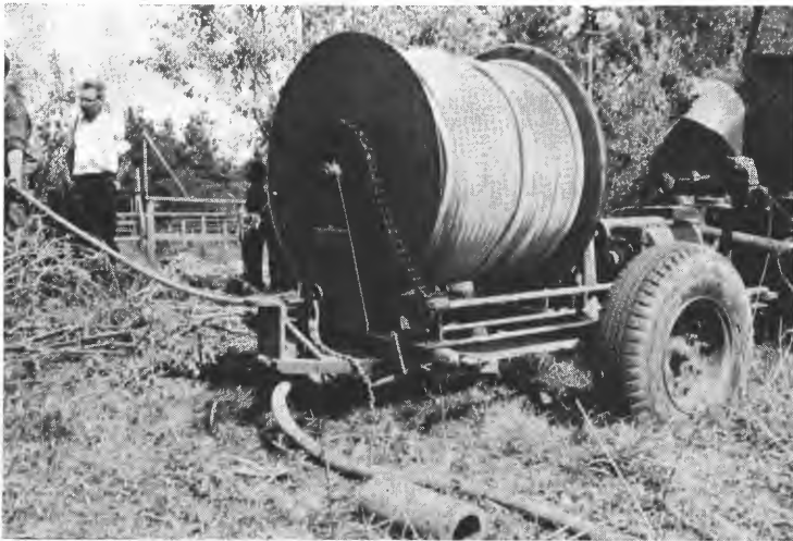
Fig. 1. Pumpen og trommelen med den 200 m lange spyleslangen er montert på en tilhenger, og pumpen drives direkte fra traktorens kraftuttak.
