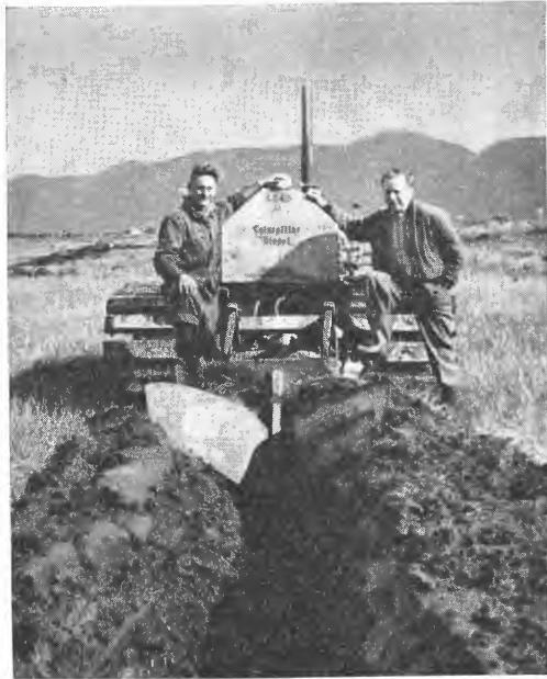
Fig. 1. Vikeidplogen. Prototypen, her festet til hydraulikken på en belte- traktor. Fot. L.T.I
