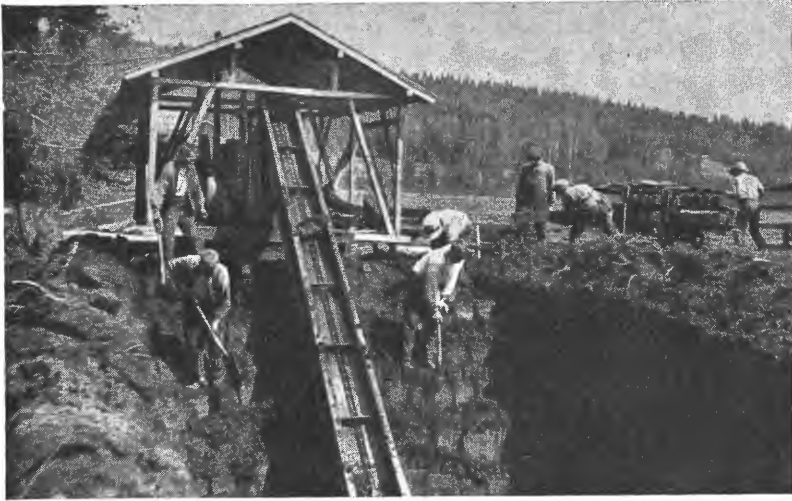
En av de store brenntorvmaskiner i virksomhet. 4—6 mann mater maskinen med torv.
