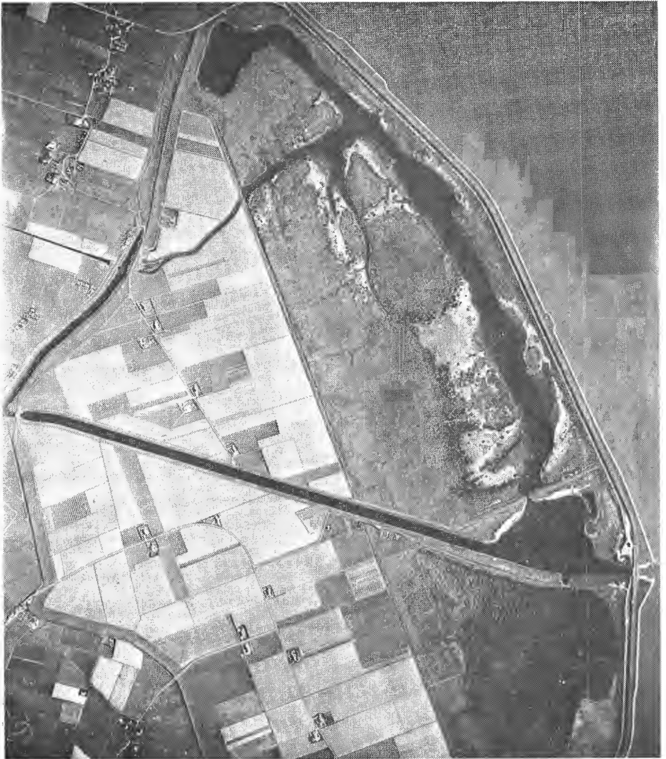
Fugleperspektiv fra Hauke-Haien-Koog området i Schleswig-Holstein. Et overbevisende eksempel på landvinning ved anlegg av demning mot kysten, kanalisering og jordforbedring. En del av det våte og sumpige marsklandet mot kystdemningen er bibeholdt i naturtilstand som fuglereservat.
