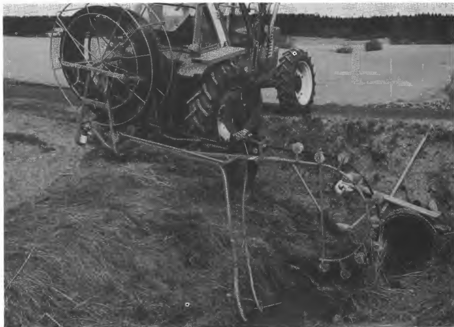
Spyleutstyret i bruk ved spyling av grøft som munner ut i åpen kanal. Ved spyling fra åpen kanal blir kostnadene ved leiespyling under en krone pr. m grøft.
