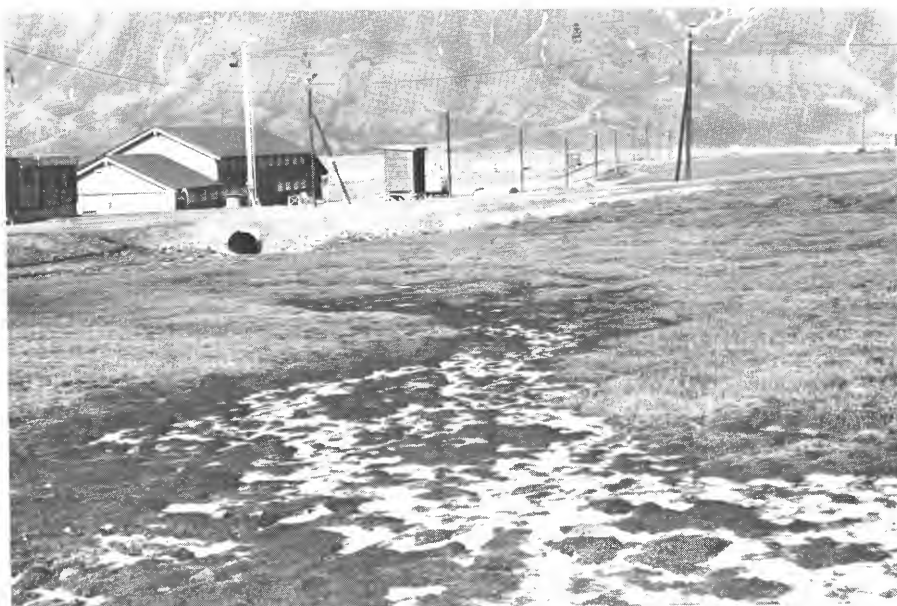
Fig. 1. Jordforgiftning på grunn av tilføring av svovelsyre og olje. De lyse feltene skyldes refleks fra vannflater. Prøve nr. 1 er tatt i forgrunnen til venstre.
