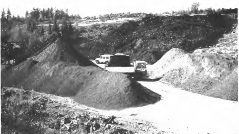
Bilde 2 Mekanisert blanding av steinmjøl og torv (30 vol.pst). Ved sikting fjernes stein og røtter (haug t.h.).
