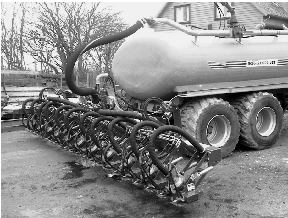
Figur 7.1 Utstyr for trykkinjeksjon av husdyrgjødsel (DGI)
