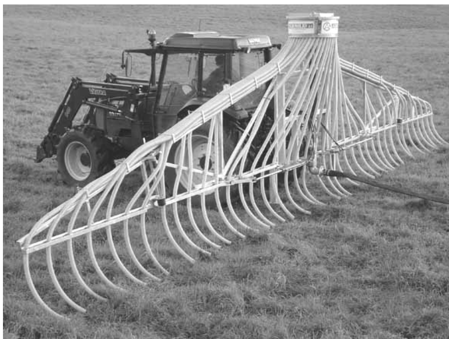
Figur 6.1 Stripespreder med slepeslange
