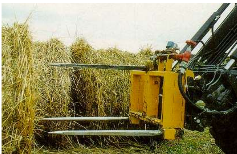
Figur 2.4 Veiing og innsprøyting av tilpasset dose ammoniakk. Innsprøyting ved hjelp av tre spyd (Felleskjøpet, 2001)
