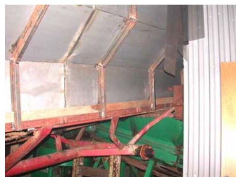
Bilde 17. Lessevogn ombygget til stasjonært matebord.
