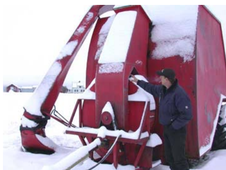
Bilde 11. Vakuum skaffes av korntørkevifte.
