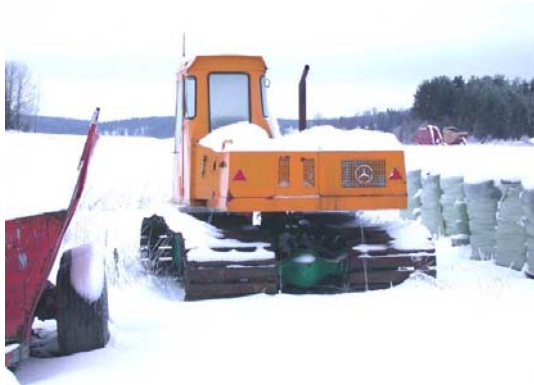
Bilde 7. Bredbeltet graver bygget av tømmerkran og løypeprepareringsmaskin.
