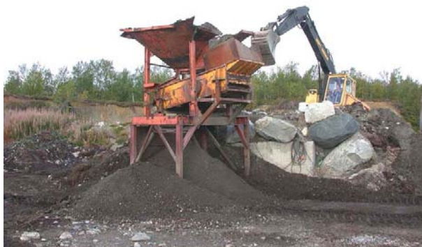
Bilde 1. Blanding av torv og sand til vekstjord.
