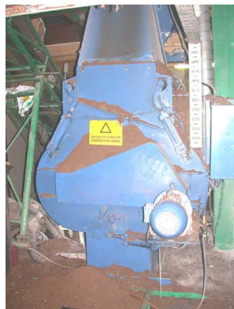
Bilde 22. Batchblander for torv, sand og dolomitt.
