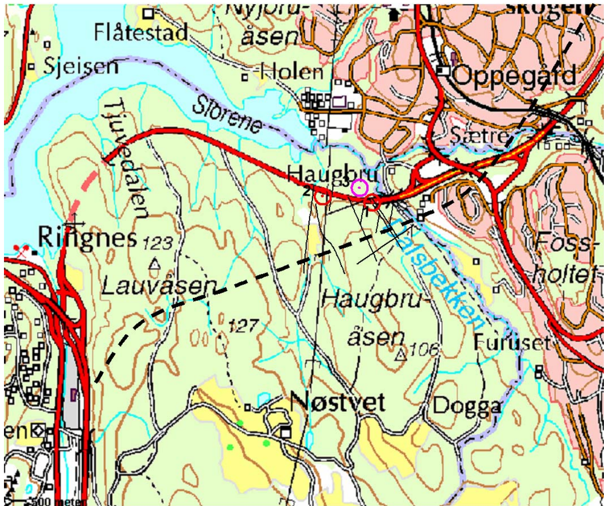
Figure 3. Topografisk kart med skisse av tunneltrase og lokale sprekkesoner i nærheten av observasjonsbrønnene. Bortsett fra Dalsbekken er det nedbørsfeltet som kan drenere til tunnelen svært begrenset. Kartet er hentet fra ngis2.statkart.no/norgesglasset/default.html .
