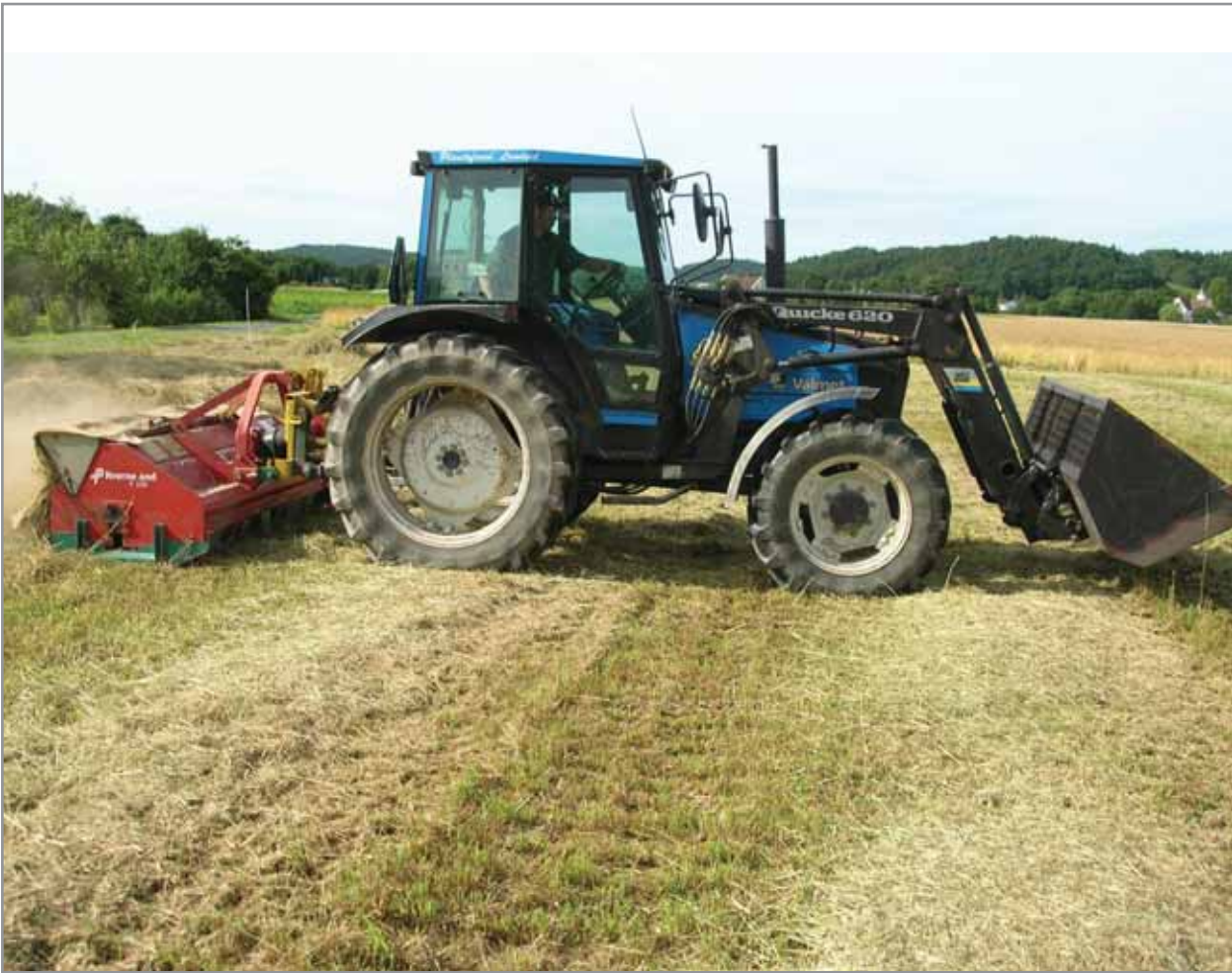
Bilde 1. Snitting av halm med traktormontert halmsnitter etter tresking i timoteifeltet på Landvik. Foto: Lars T. Havstad.
