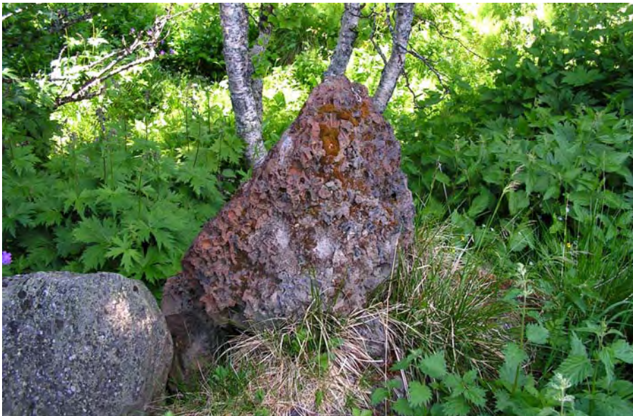
Slaggblokk funnet i setertrakter i Oppland. Slagget er avfall etter jernframstilling av myrmalm.
