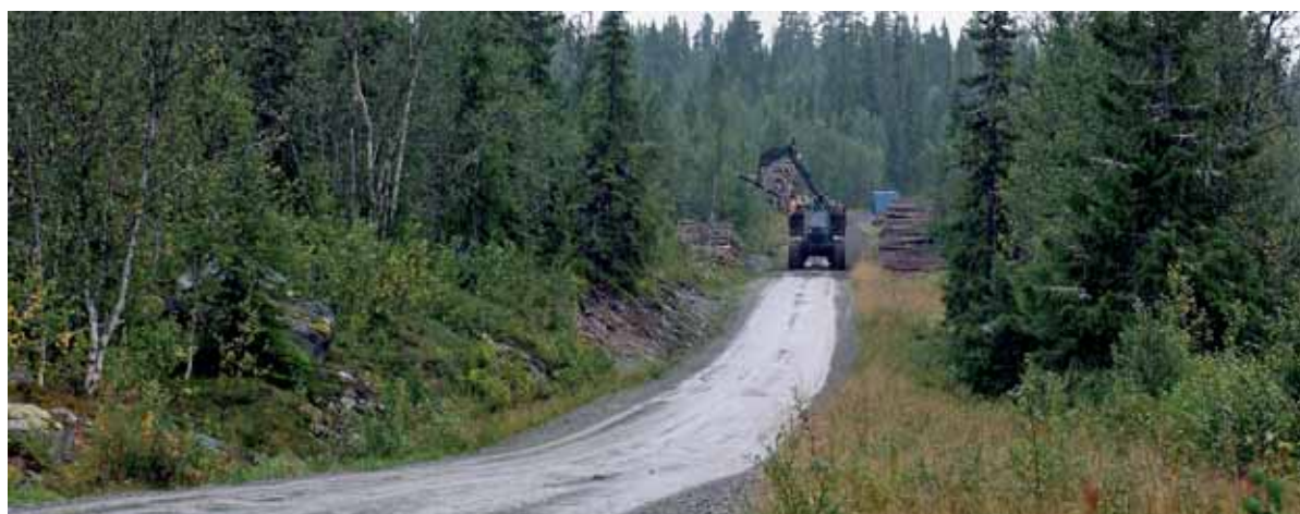
Driftsveglengde er avstanden som tømmeret må transporteres fram til velteplass. Lassbærer frakter tømmer til Birkebeinervegen. Stor-Elvdal, Hedmark.
