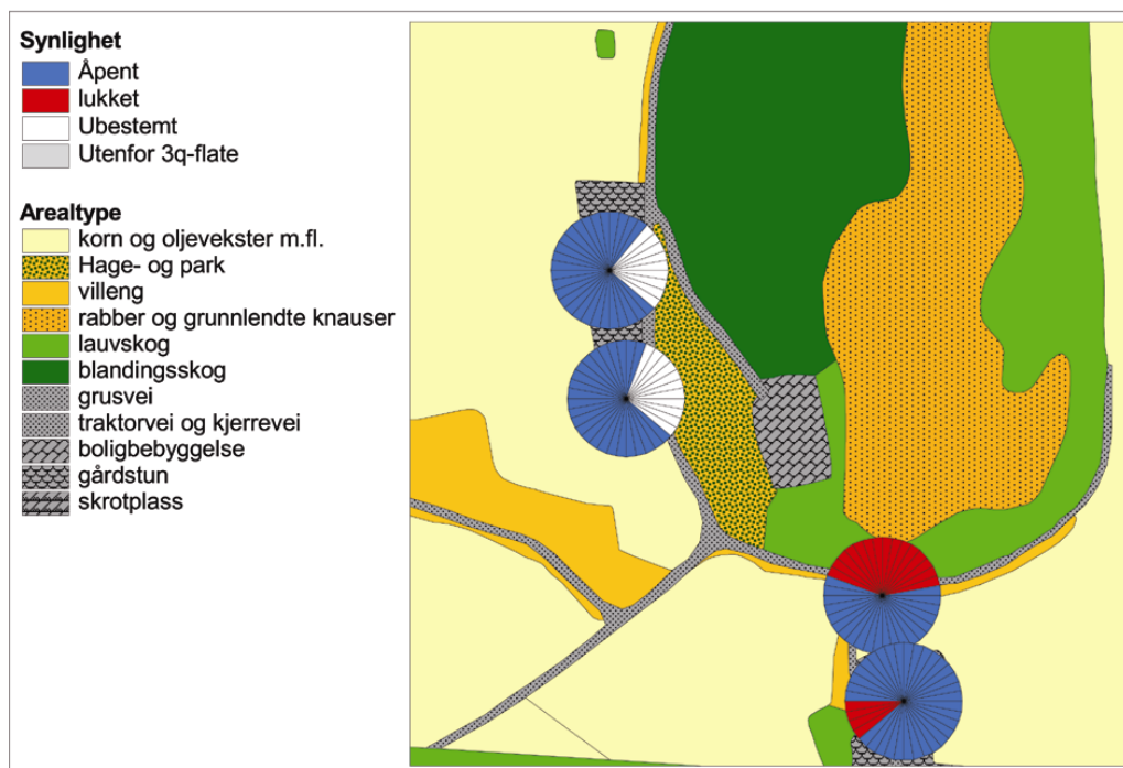
Figur 3: Synlighet beregnes som prosentandel av sektorer i en sirkel rundt kulturminnet som er av åpne arealtyper. Indikatoren måler grad av innsyn fra utenfor den 25 m radius sirkelen til kulturminnet i sentrum av sirkelen. Dette er illustrert i figuren for fire kulturminner; de blå sektorene er på åpne arealtyper, de hvite er på arealtyper som ikke kan defineres som enten åpen eller lukket, mens i de rød sektorene er innsyn til sentrum sperret av lukkede arealtyper (skog).
