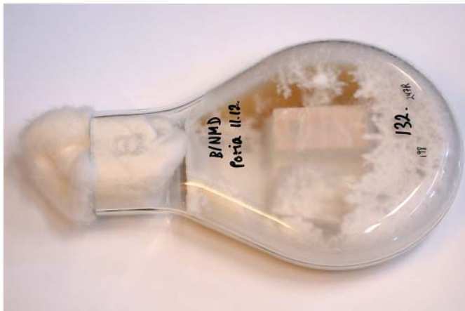
Nedbrytningstest med brun-råtesoppen Poria placenta . Dette er en norsk og europeisk prøvemåte for å bestemme den beskyttende effekten mot treødeleggende basidiomyceter (stilksporesopper). Foto: Gry Alfredsen
