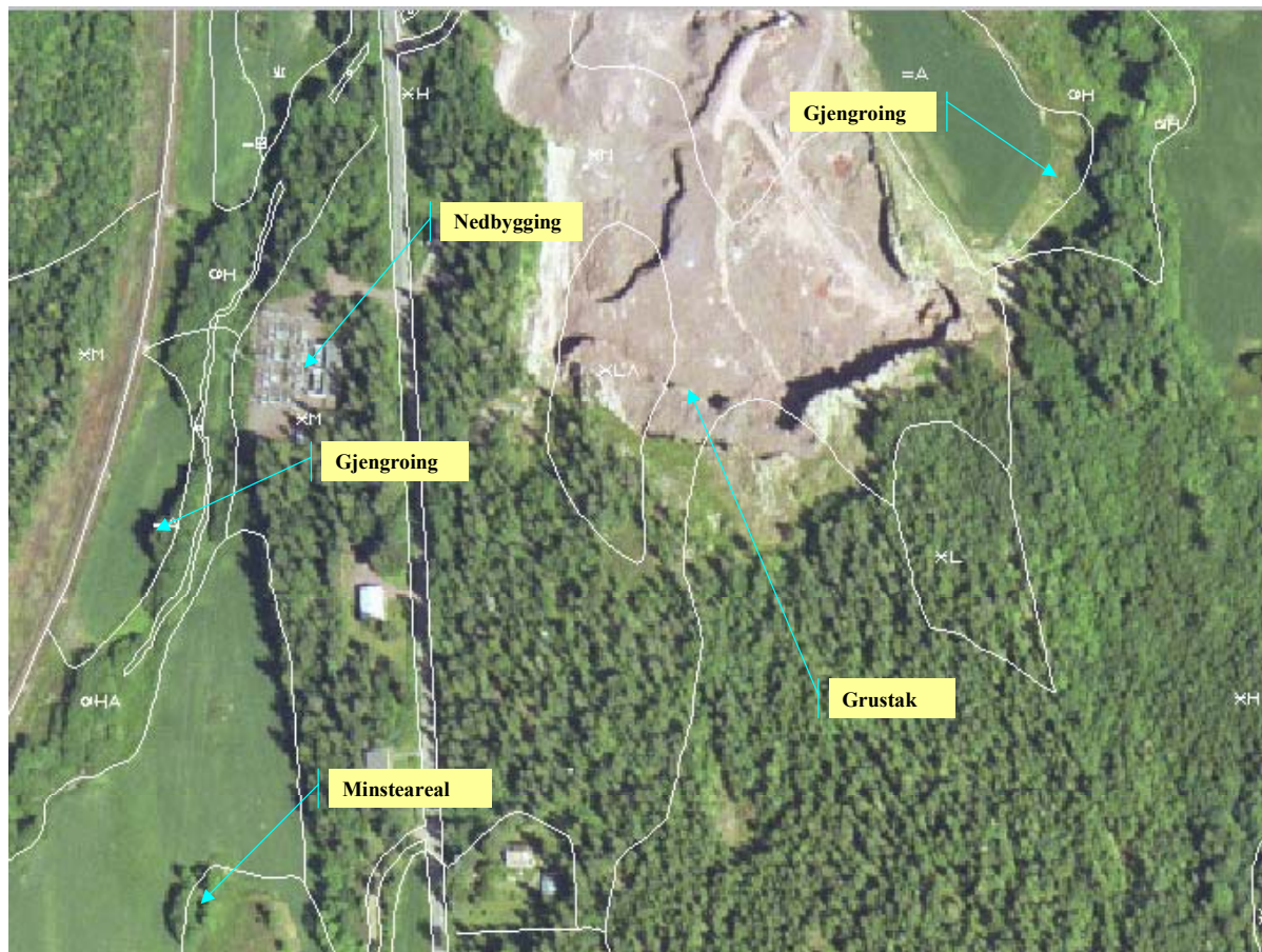
Figur 4. Ortofoto i kombinasjon med eldre FKB er et fremragende hjelpemiddel til å avdekke feil og endringer.
