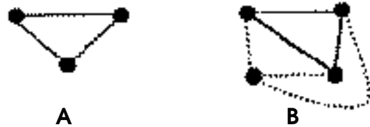
Figur 3: Når antallet knutepunkter i et nettverk øker fra tre (A) til fire (B) øker antallet forbindelseslinjer fra tre (A) til seks (B).
