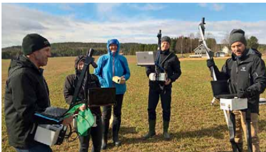
Bilde 1. Kalibrering av Yara N-sensorer. Foto: Annbjørg Øverli Kristoffersen.
