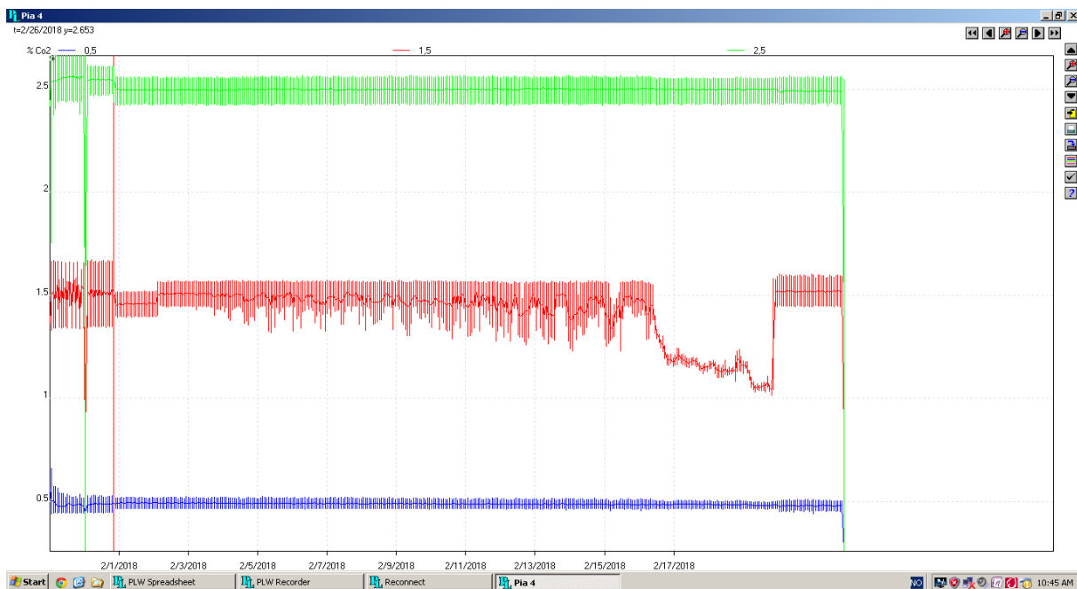
Figur 15. Registrert CO 2 nivå på forsøkslageret 31. januar til og med 21. februar. 25000 ppm (grønn), 15000 ppm(rød) og 5000 ppm (blå).
