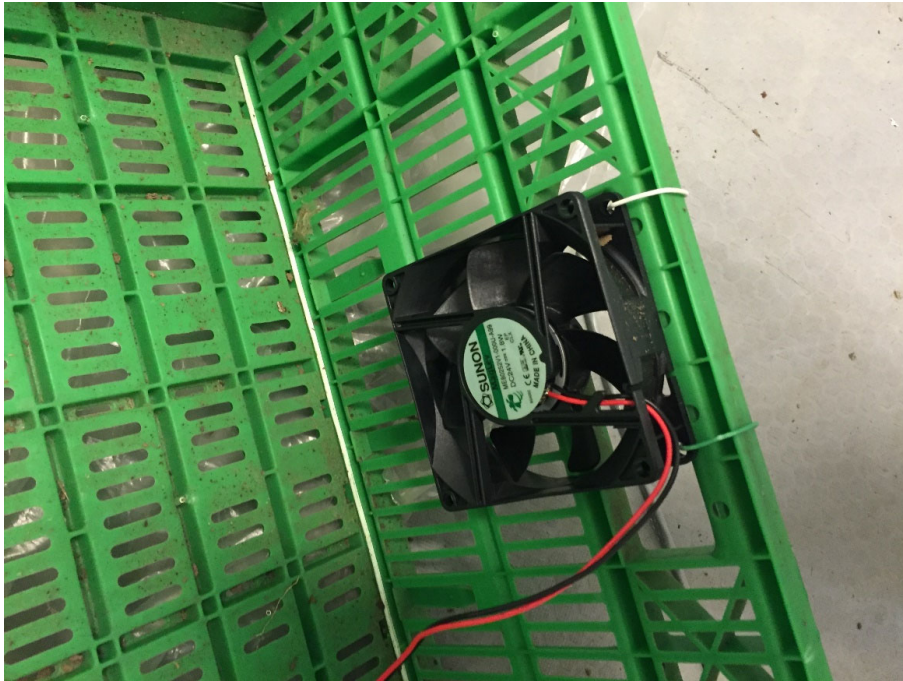
Bilde 2. Vifte i kassen for å få best mulig luftfordeling i potetprøven
