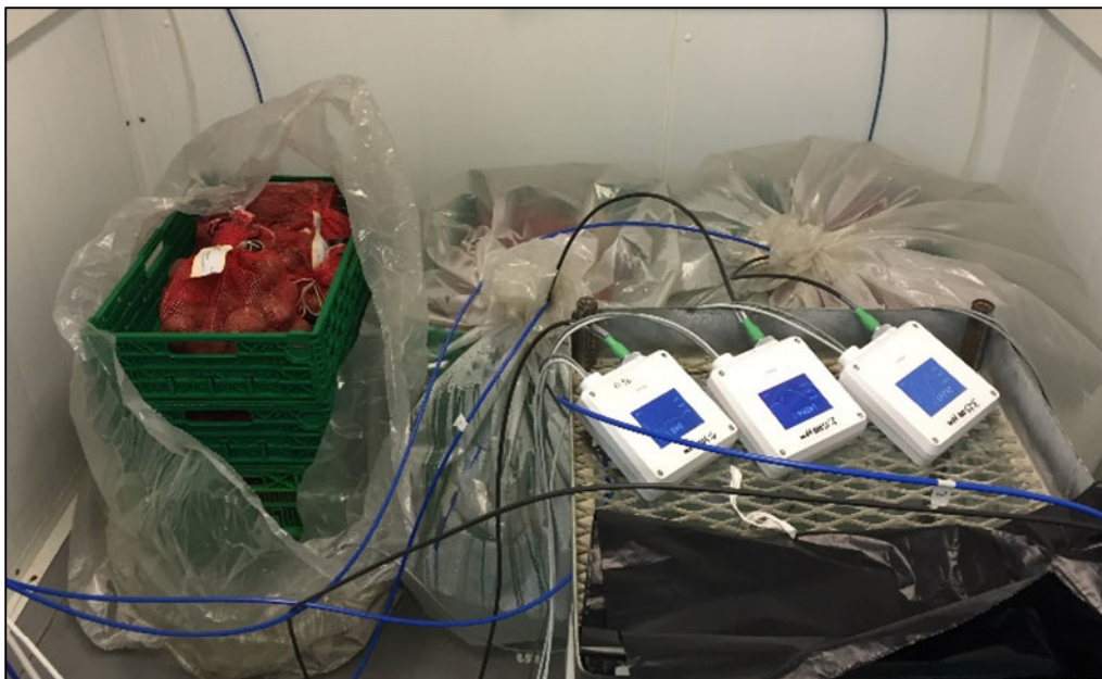
Bilde 1. Potet prøver i forsøkslager på SKP. 3 CO 2 målere var forbundet med hver sitt kammer med ulik CO 2 nivå.
