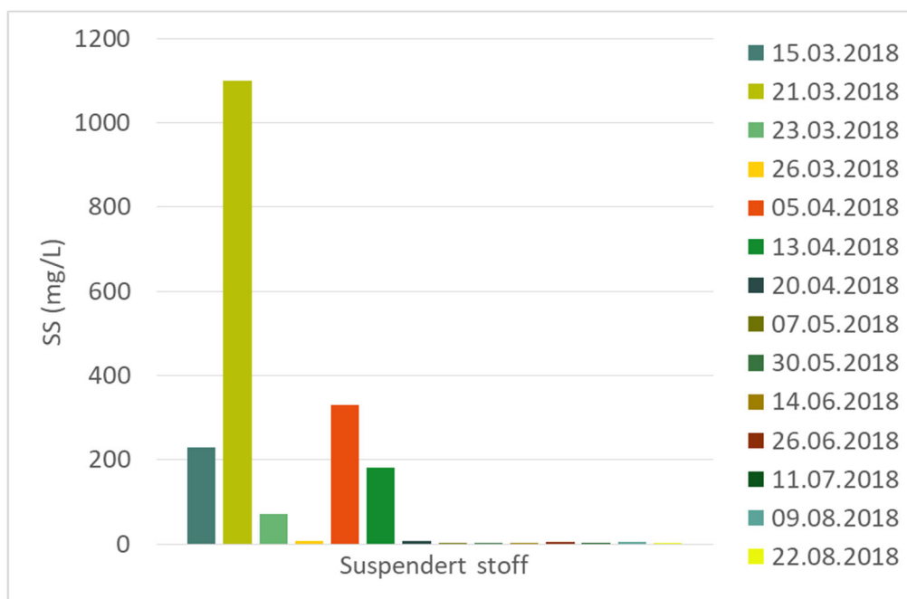
Figur 8. Suspendert stoff (mg/L) i alle vannprøver i avrenningen fra åsland snødeponi, datoene 7 og 30 mai var SS konsentrasjonen 2 mg/L og det vises ikke på denne skalaen.
