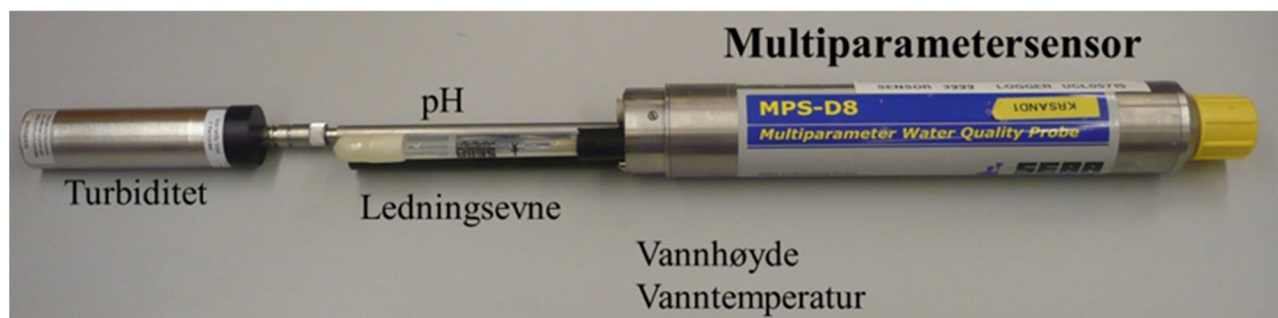
Figur 5. Multiparametersensor for automatisk overvåking av vannkvalitet.
