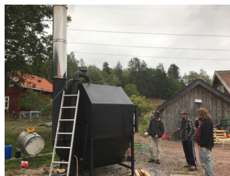
Fig. 6.1. Gårdsbasert pilot biokullovn på gården til Helge Hauge (Sætre, 2018). Bilde: Adam O'Toole
