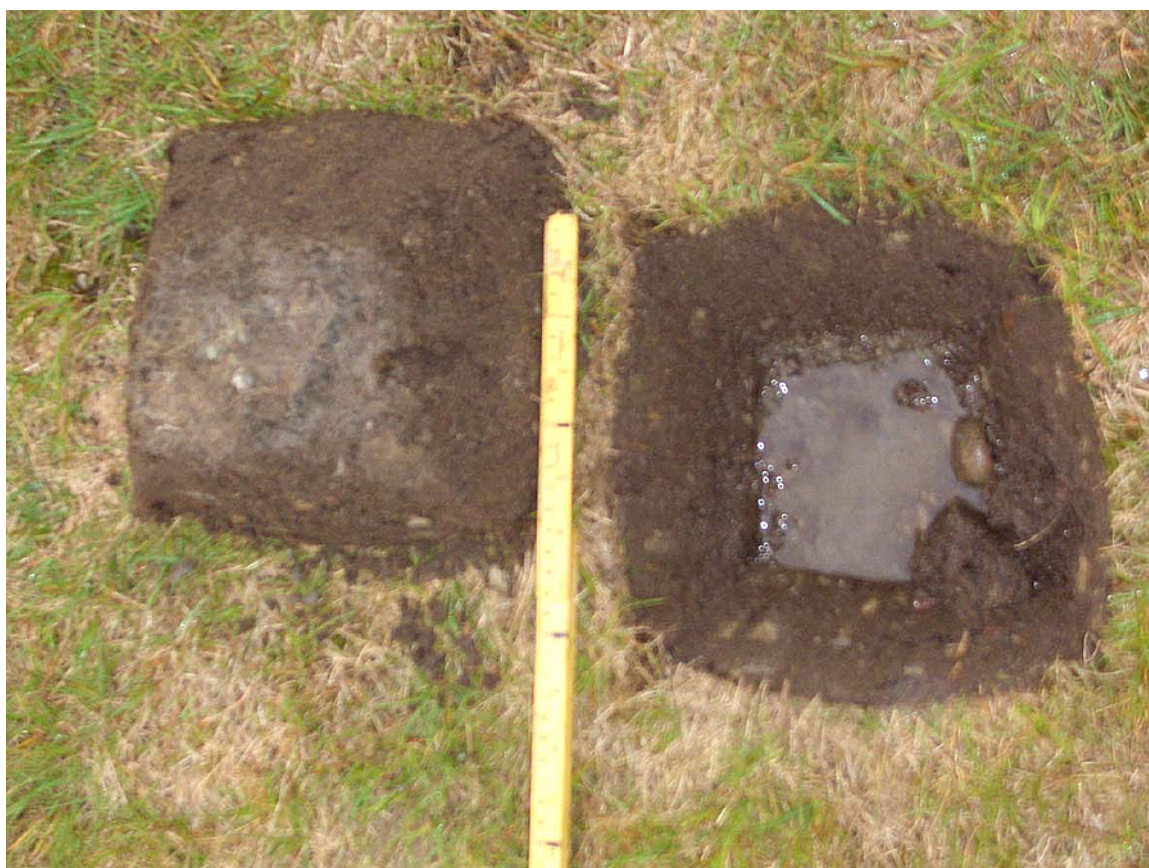
Figur 10. Stagnerende vann i nedre del av topplaget over en komprimert leirjord på et plenareal med dårlig plantebestand (Foto: Tore E. Sveistrup)
