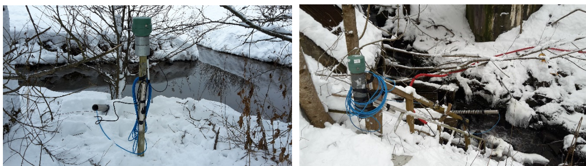
Figur 2.7: Automatisk multiparametersensorer installert i felt i Bølerbekken oppstrøms (BØKL-O) til venstre, og Bølerbekken nedstrøms (BØL-N) til høyre
