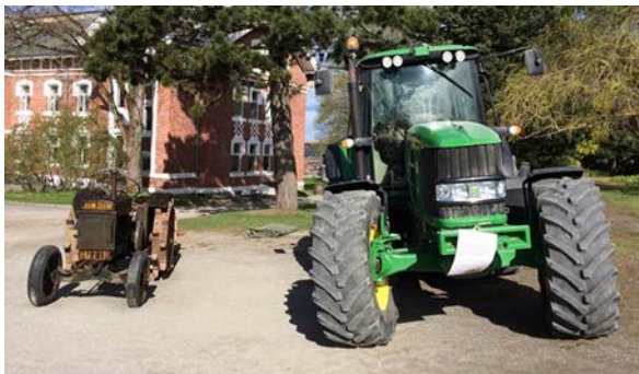
Figur 12. Jo tyngre utstyr desto større pakking. (Bilde: A-G.B. Blankenberg, NIBIO)
