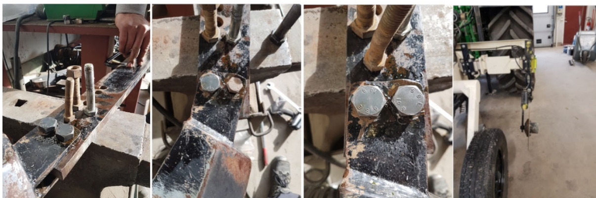
Bilde 3. Utbedret spade for pH målinger(f.v.), Vinkel på Spade før utbedringer , vinkel etter utbedring av spade, kjøreskade på rullekniver til EC-målinger(t.h.),.
