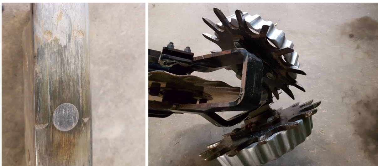
Bilde 4. Utsnitt IR/R sensor (t.v.) og skadet rullekniv foran på Veris MSP3 (t.h.).
