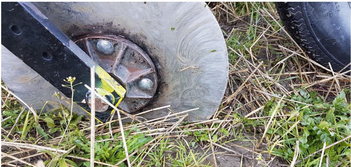
Bilde 7. Arbeidsdybde rullekniver til EC-målinger Veris MSP3.
