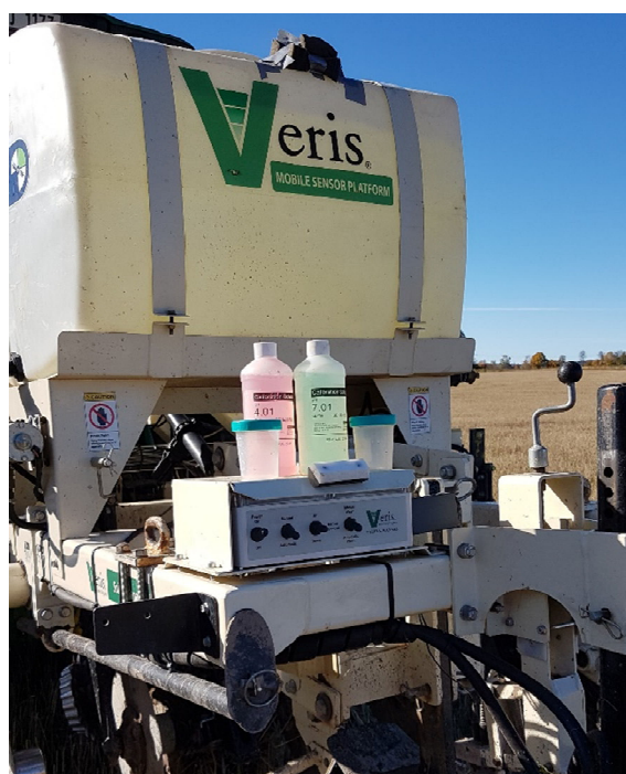
Bilde 2. Veris MSP3 med pH-konsentrater (i flaske) og IR-blokk klar til kalibrering.
