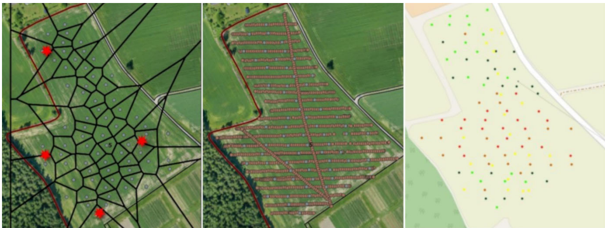
Bilde 11. Voronoi av Veris/Eurofins jordprøver satt opp mot kalibrering (t.v.), OM målinger fra Veris lagt inn i QGIS (i midten), Fieldfusion pH malinger (t.h.).
