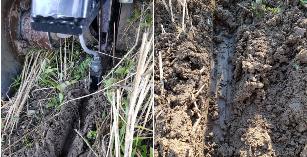
Bilde 6. Arbeidsdybde og vinkel til IR/R sensor Veris MSP3 (t.v.) og synlig gode spor etter god kontakt mellom jord og IR/R sensor Veris MSP3 (t.v.).
