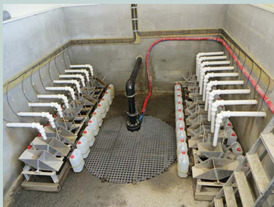
Figur 2. Vannføringsmåling gjøres ved å telle antall vipp med vippekarene og uttak av vannprøver skjer ved oppsamling av delprøver hver gang vannet renner over kannene.
