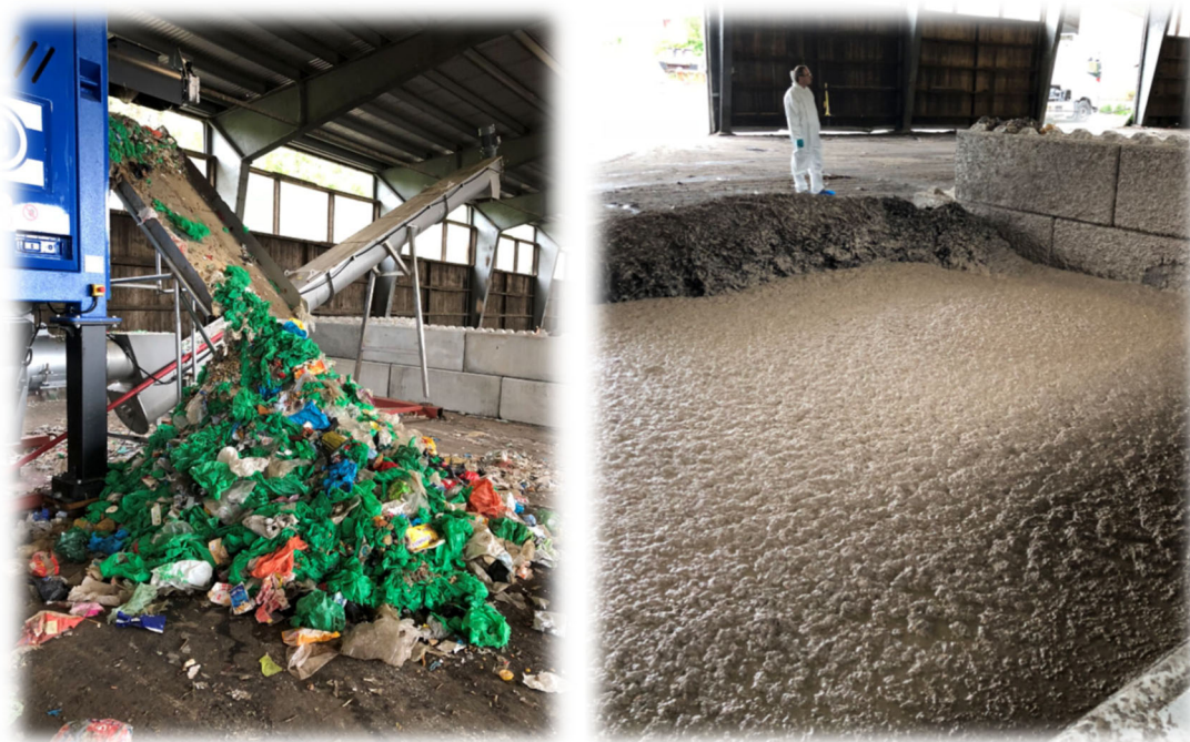
Figur 15. Sammenstilling av forbehandlings maskin som separerer ut plast (venstre side) fra det kildesortert matavfallet (høyre side).
