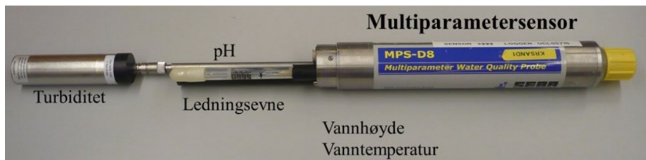
Figur 5. Multiparametersensor for automatisk overvåking av vannkvalitet.
