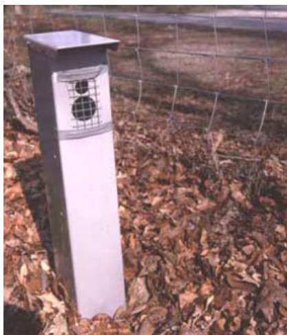
Figur 2. Stolpen med IR sensor i Ugchelen, NL. Gitter beskytter sensorvindu mot hekkende fugler (Foto: Marcel Huijser; bildet fra Huijser m.fl. 2005)
