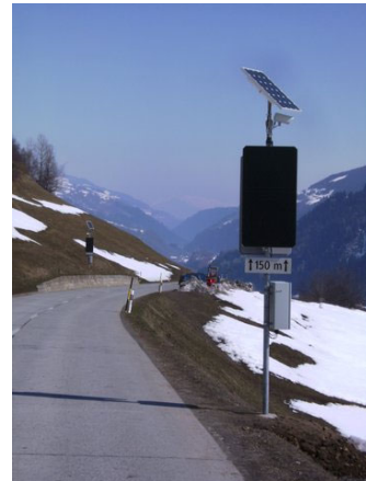
Figur 26. Interaktive eller “dynamiske” vilvarselskilt langs veien – varsellys til bilister ble utløst av vilt (for eksempel gjennom varmesøkende sensorer, til venstre et eksempel fra E6 i Nord-Trøndelag https://www.nrk.no/trondelag/unik-viltvarsler-pa-e6-1.8367905 ). Til høyre en modell fra firmaet Calonder i Sveits som bruker en kombinasjon av kamera og IR sensorer (bildet brukt med permisjon av Calonder Energy AS).
