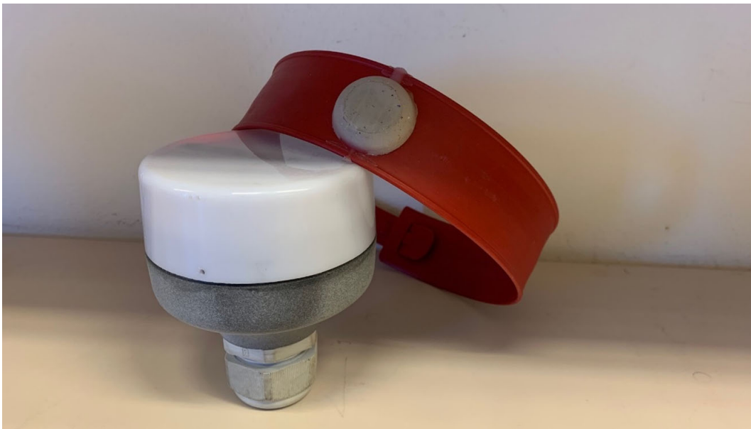
Figur 41. Radiosender og mottak, integret i hhv. halsklave av plast og blinklysholder (Foto: Johannes Karlsson, Universitetet i Umeå).
