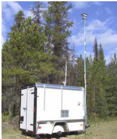
Figur 4. Tilhenger og IR kamera system (v) og varsel skilt langs vei(h) i Kootenay, British Columbia, CAN (Foto: Tim McAllister, bildet fra Huijser m.fl. 2005)
