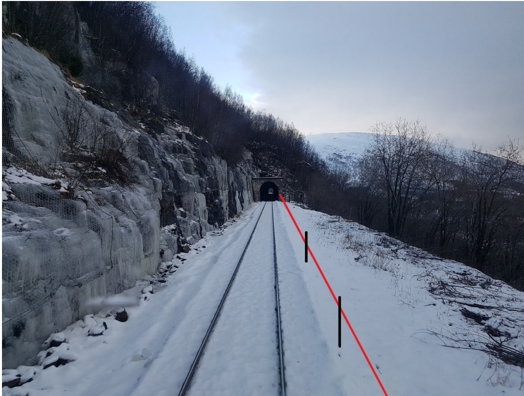
Figur 45. Området mellom tunneller hvor dyrene oppholder seg ofte. En mulig overvåkingssystem kunne være en rekke sensorer langs jernbanespor (stolper for å befeste sensorer symbolisert av vertikale svarte linjer; sensorretningen symbolisert av rød linje; bildet tatt av Wagner G under beferingen).
