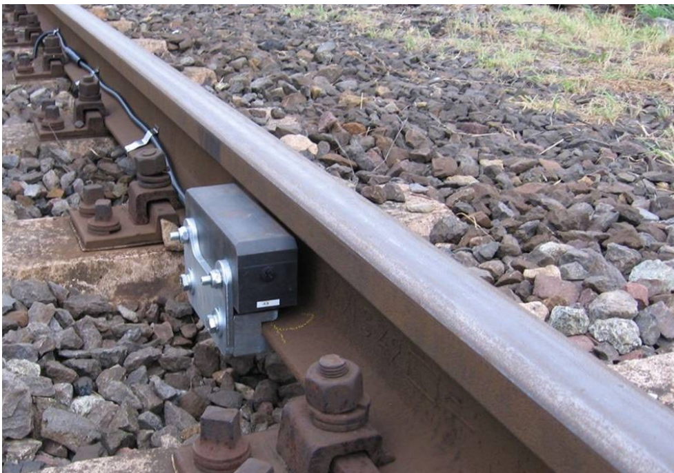
Figur 21. "Wheel sensors" varsler systemet om tog i nærheten (Neel, PO).
