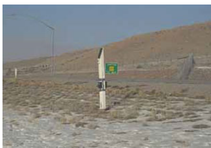
Figur 3. FLASH system med (v.t.h.) IR sensor langs veg, IR scope og geophones gravt ca. 10 cm ned i bakken i Nugget Canyon, USA (Fotos: WYDOT; bildet fra Huijser m.fl. 2005).
