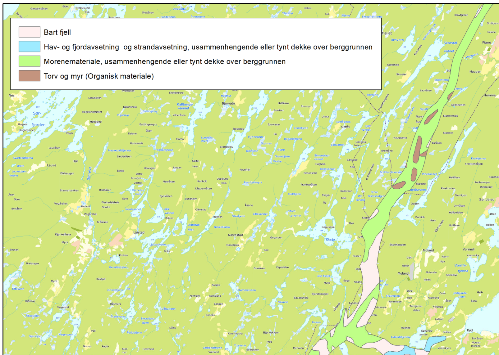
Figur 2.3.3. Løsmasser i midtre del av korridor.
