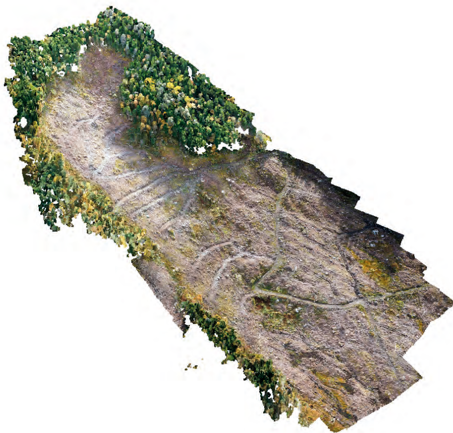
3D-modell: Ved hjelp av laserpulser som skytes mot bakken fra fly lages tredimensjonale terrengmodeller. Her kombinert med bilder tatt fra drone. Fra et hogstfelt på Voss i Hordaland. (Foto: Skog og landskap)
