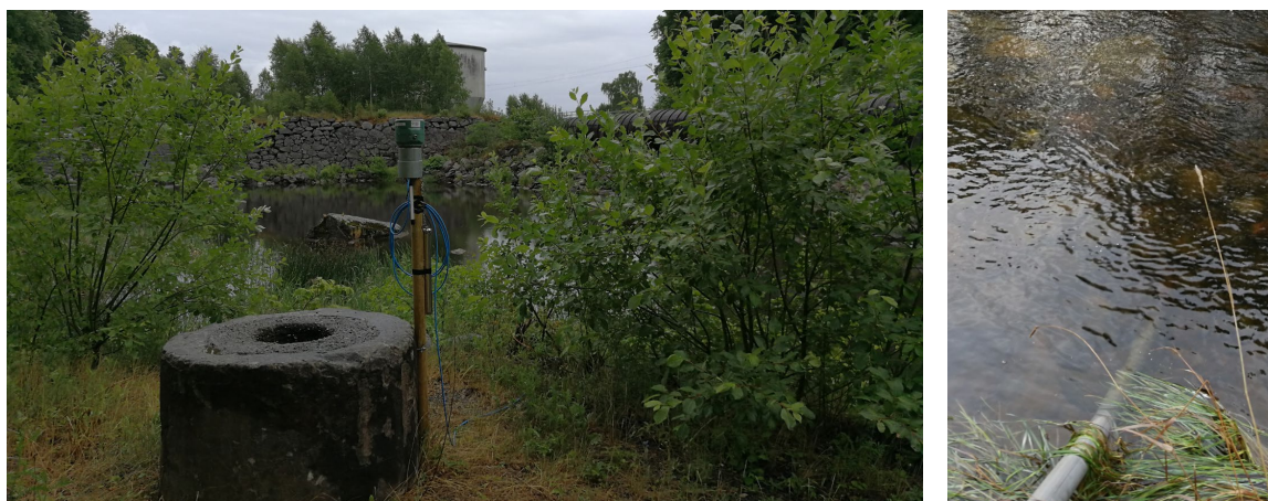
Figur 4. Plassering av automatisk måleutstyr for vannkvalitet i dam i Farriselva (Stasjon FELV). Logger på stolpe og sensor i foringsrør.
